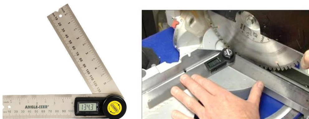
รูปที่ 2.7 แสดงบรรทัดวัดมุมและการใช้งาน (ที่มา : Trend Routing. 2010)
