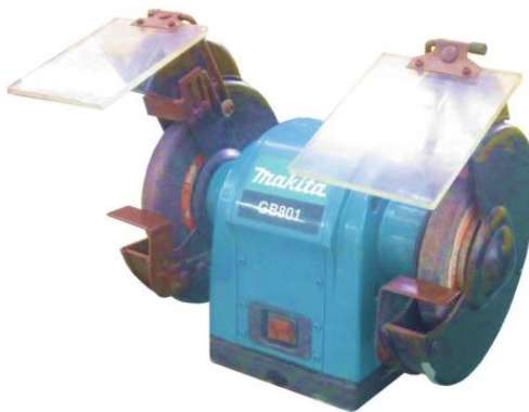
รูปที่ 2.1 เครื่องเจียรไนลับคมตัดแบบตั้งโต๊ะ (ที่มา : วารินยา ชันศิลา.2560)
