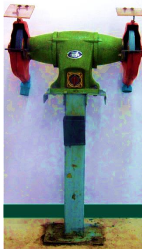
รูปที่ 2.2 เครื่องเจียระไนลับคมตัดแบบตั้งพื้น (ที่มา : วารินยา ชั้นศึลา.2560)
