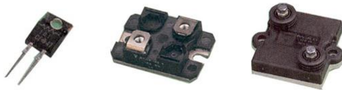
รูปที่ 2.12 แสดงลักษณะรูปร่างของรีโอสตาทแบบต่างๆ ที่มีอัตราทดกำลังวัตต์สูง
