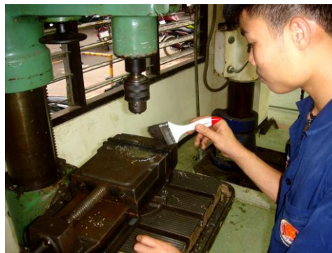
รูปที่ 3.28 การทำความสะอาดเครื่องเจาะเมื่อปฏิบัติงานแล้วเสร็จ ( ที่มา : ปริญญา ปัญญาศรี , 2560 )
