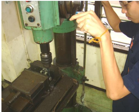
รูปที่ 3.26 การเจาะชิ้นงานด้วยเครื่องเจาะ ( ที่มา : ปริญญา ปัญญาศรี , 2560 )
