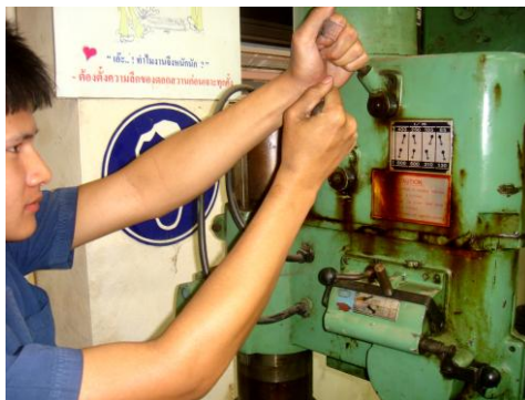
รูปที่ 3.25 การปรับเปลี่ยนความเร็วรอบบนเครื่องเจาะตั้งพื้น
