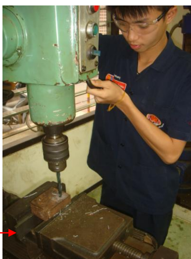
รูปที่ 3.24 การใช้แท่งขนานรองรับชิ้นงานเวลาเจาะชิ้นงานด้วยเครื่องเจาะ
