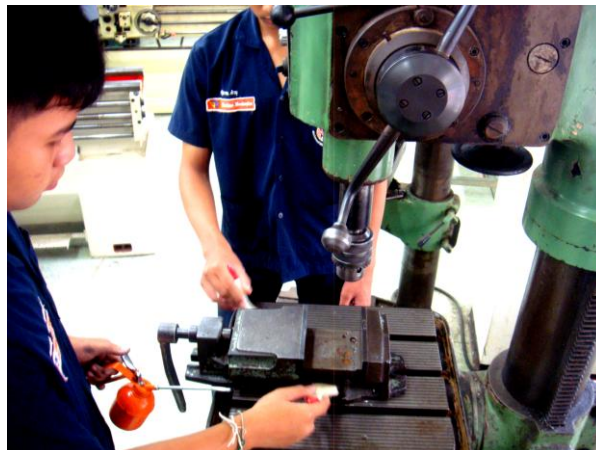
รูปที่ 3.34 แสดงการชโลมน้ำมันหลังจากการทำความสะอาดเครื่องเจาะ ( ที่มา : ปริญา ปัญญาศรี , 2560)
