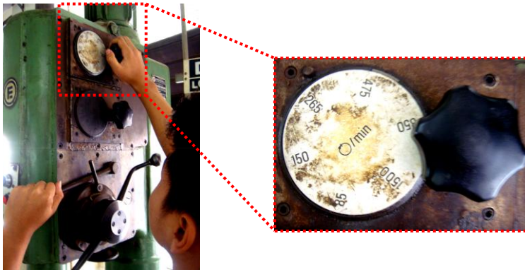
รูปที่ 3.31 แสดงการปรับตั้งความเร็วรอบของเครื่องเจาะต่งพื้น ( ที่มา : ปริญา ปัญญาศรี , 2560 )
