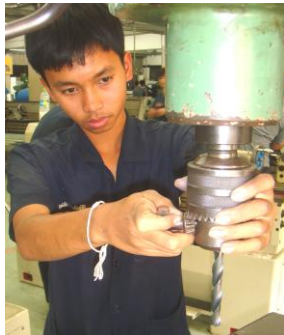
ก. การจับยึดดอกสว่านกับงานตรงด้วยหัวจับดอกสว่าน ข. จับยึดดอกสว่านกับงานเรียบด้วยเพลาเครื่องเจาะ
