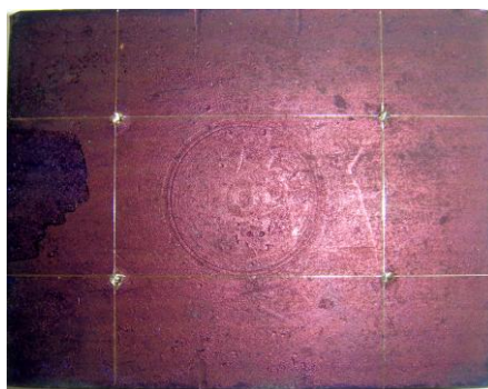
รูปที่ 3.29 การขีดเส้นร่างแบบและตอกนำศูนย์เพื่อกำหนดตำแหน่งรูเจาะ
