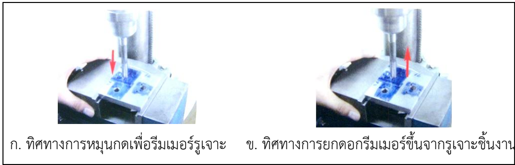
รูปที่ 3.28 แสดงการรีมเมอร์ชิ้นงานด้วยรีมเมอร์บนเครื่องเจาะตั้งพื้น ( ที่มา : ปริญา ปัญญาศรี , 2560 )
