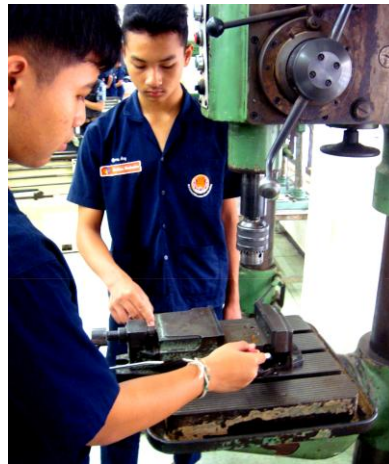
รูปที่ 3.33 แสดงการทำความสะอาดเครื่องเจาะหลังจากการปฏิบัติงานเสร็จ ( ที่มา : ปริญา ปัญญาศรี , 2560)
