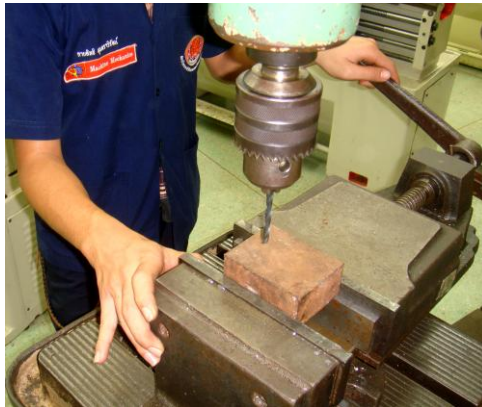
รูปที่ 2.24 การจับยึดชิ้นงานด้วยปากกาบนเครื่องเจาะ
