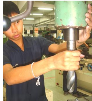
ก. การจับยึดดอกสว่านกับงานตรงด้วยหัวจับดอกสว่าน ข. จับยึดดอกสว่านกับงานเรียบด้วยเพลาเครื่องเจาะ
