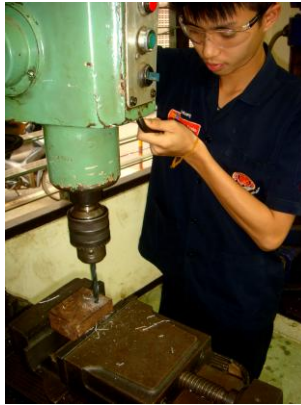
รูปที่ 3.23 การสวมแว่นตานิรภัยในขณะที่ทำการเจาะชิ้นงานบนเครื่องเจาะ ( ที่มา : ปริญา ปัญญาศรี , 2560 )
