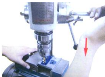
รูปที่ 3.32 แสดงทิศทางการตัดชิ้นงานด้วยดอกตัดขนาดตัดด้วยเครื่องบนเครื่องเจาะตั้งพื้น ( ที่มา : ปริญา ปัญญาศรี , 2560 )
