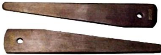
รูปที่ 3.7 แสดงลักษณะของเหล็กถอดดอกสว่าน ( ที่มา : ปริญา ปัญญาศรี , 2560 )
