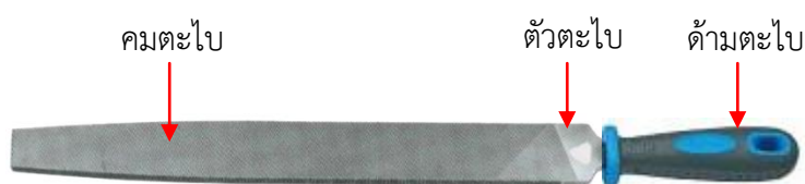
รูปที่ 1.97 แสดงส่วนประกอบของตะไบ ( ที่มา : ปริญญา ปัญญาศรี , 2560 )
