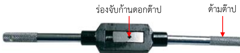
รูปที่ 1.98 แสดงส่วนประกอบของด้ามตีป ( ที่มา : ปริญญา ปัญญาศรี , 2560 )
