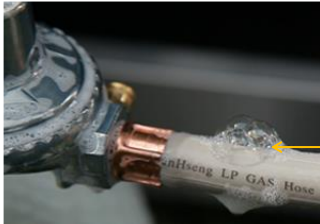
รูปที่ 1.16 แสดงการทดสอบการอยรั่วด้วยฟองสบู่
