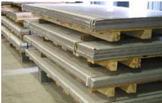
รูปที่ 1.17 แสดงลักษณะการจัดเก็บโลหะแผ่น
