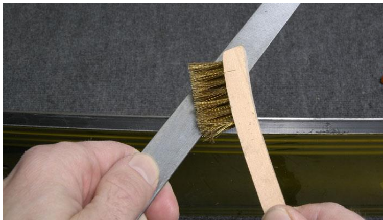
รูปที่ 1.23 แสดงลักษณะการใช้แปรงลวดทองเหลืองทำความสะอาดตะไบ
