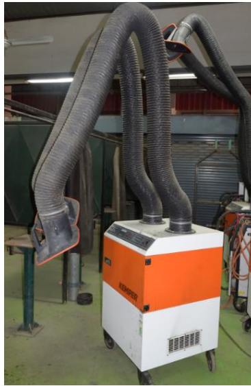
รูปที่ 1.11 แสดงลักษณะเครื่องดูดควันแบบเคลื่อนที่
