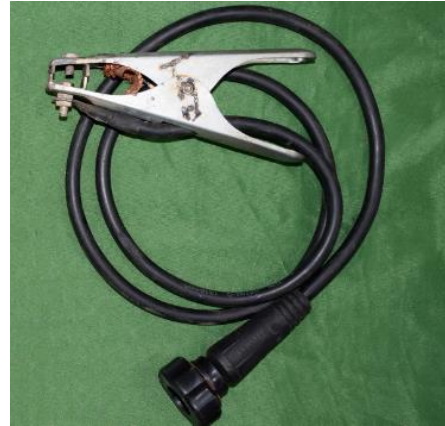
รูปที่ 1.3 แสดงลักษณะสายไฟและที่ยึดสายดิน
