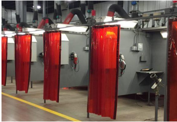
รูปที่ 1.9 แสดงลักษณะห้องเชื่อมที่มีฉากกันรังสีจากการอาร์กและปล่องดูดควันเชื่อม
