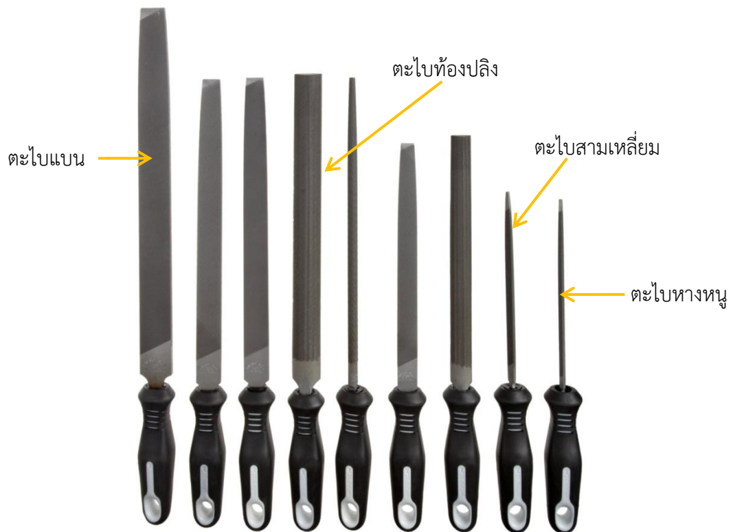
รูปที่ 1.21 แสดงลักษณะของตะไบแบบต่างๆ
