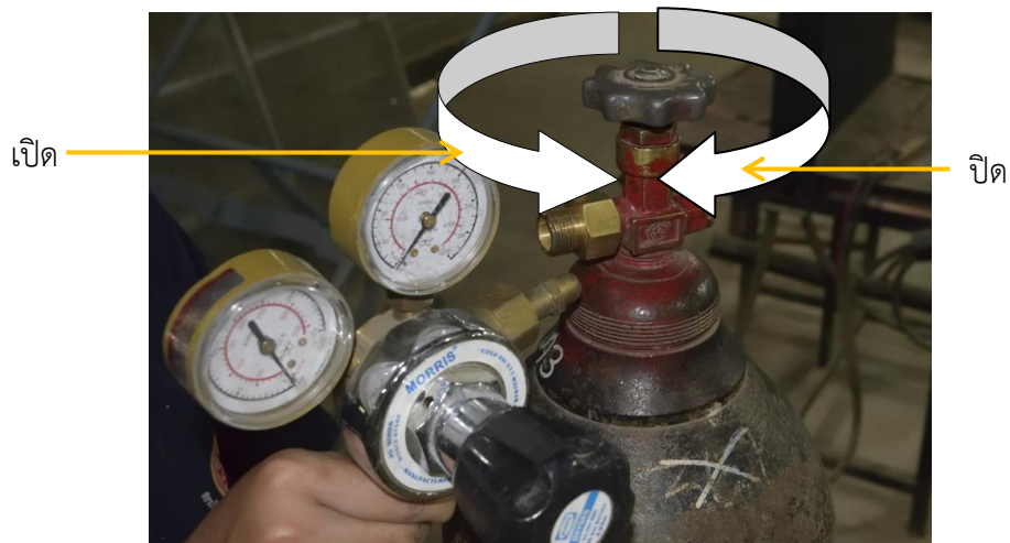
รูปที่ 1.15 แสดงการทำแคว์กริ่งเพื่อทำความสะอาดทางออกข้อต่อหัวถังออกซิเจน
