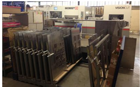
รูปที่ 1.17 แสดงลักษณะการจัดเก็บโลหะแผ่น
