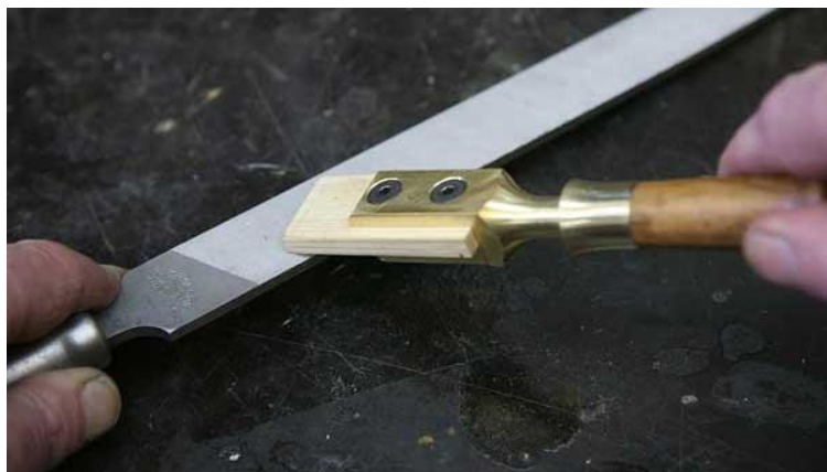
รูปที่ 1.24 แสดงลักษณะการทำความสะอาดตะไบด้วยแท่งทำความสะอาด
