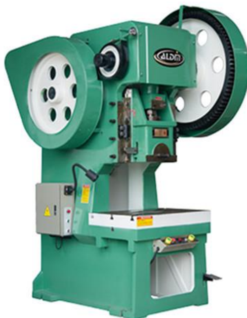
รูปที่ 1.33 แสดงลักษณะเครื่องปั๊มโลหะ
