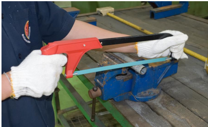
รูปที่ 1.20 แสดงลักษณะการจับเลื่อยมือเลื่อยชิ้นงานที่ถูกต้อง
