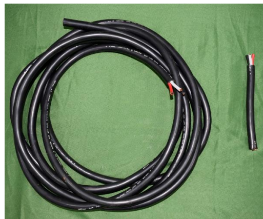
รูปที่ 1.4 แสดงลักษณะแตกต่างระหว่างสายไฟฟ้าต่อเข้าเครื่องเชื่อมกับสายเชื่อม
